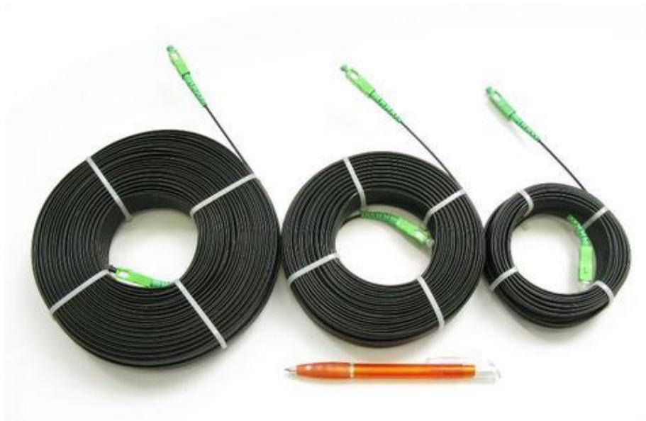
**Дроп-Кабель Навивной (ДКН)** применяется для быстрого и надежного подключения абонентов в воздушных сетях FTTH, обеспечивая соединение абонентского терминала с дроп-муфтой с оптическим кроссом без проведения работ по сварке или оконцовке оптических волокон в полевых условиях.
