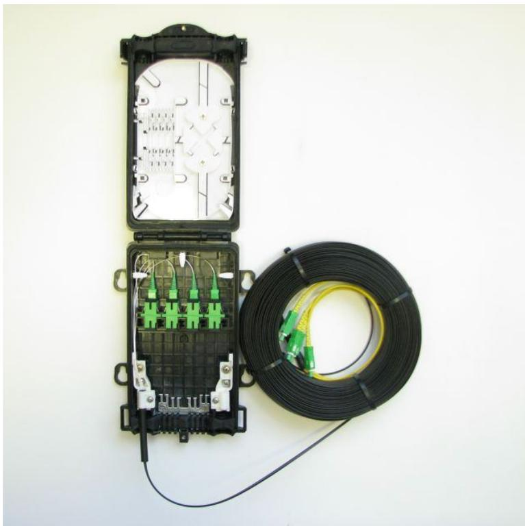
Оптическая муфта МКН с подключенной бухтой оконцованного оптическими разъемами распределительного навивного кабеля используется в сетях FTTH как узел абонентских подключений (дро-п-муфта с оптическим кроссом), устанавливаемый на опоре воздушной линии. Применение МКН позволяет проводить развертывание или расширение распределительной части сети без проведения работ по сварке или оконцовке оптических волокон в полевых условиях.
