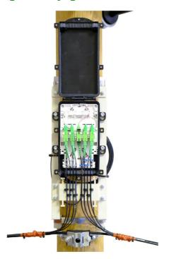
Оптическая дроп-муфта МКО-П1 используется в сетях FTTH как узел абонентских подключений (дроп-муфта с оптическим кроссом), устанавливаемый на опоре воздушной линии. Применение МКО-П1 позволяет проводить развертывание или расширение распределительной части сети без проведения работ по сварке или оконцовке оптических волокон в полевых условиях.
