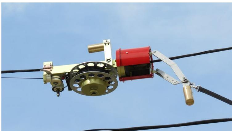
Навивочная машинка WF-300 используется для укладки на несущий элемент тонкого оптического микрокабеля в виде спирали, охватывающей несущий элемент – ОКСН, диэлектрический или металлический трос.
